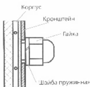
Рис. 3а. Крепление кронштейнов к корпусу
