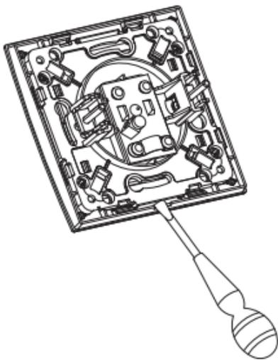
Снять внутреннюю часть лицевой части розетки, путем легкого отжатия наконечником плоской отвертки пластиковой части и декоративной рамки.
