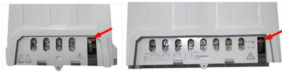
Рисунок 3.2 – Расположение переключателя блокировки управления нагрузкой счетчиков «Меркурий 208» (слева) и «Меркурий 238» (справа)
