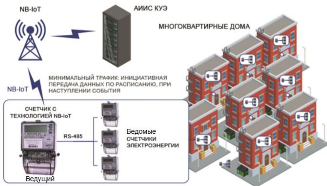
Рисунок 3.4 – Схема работы счетчика NB-IoT в составе АИИС КУЭ
