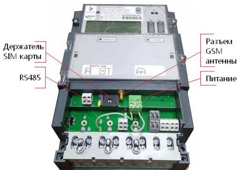
Рисунок 4.6 – Вид счетчика «Меркурий 234» с модулем GSM с элементами подключения
