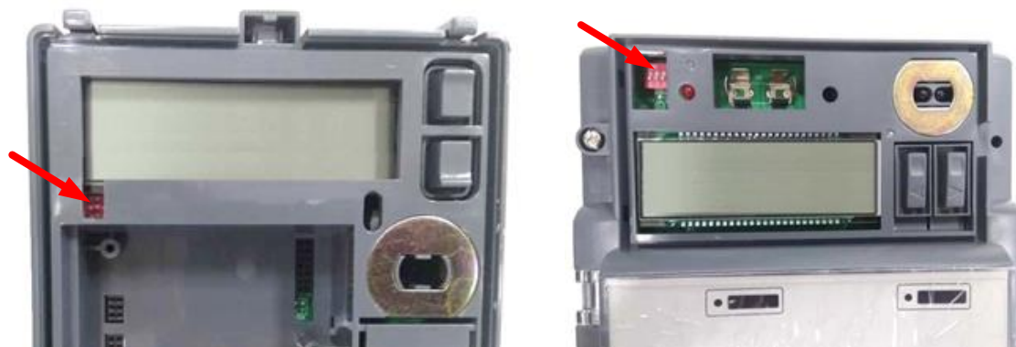
Рисунок 3.1 – Расположение переключателя блокировки управления нагрузкой счетчиков «Меркурий 204» (слева) и «Меркурий 234» (справа)
