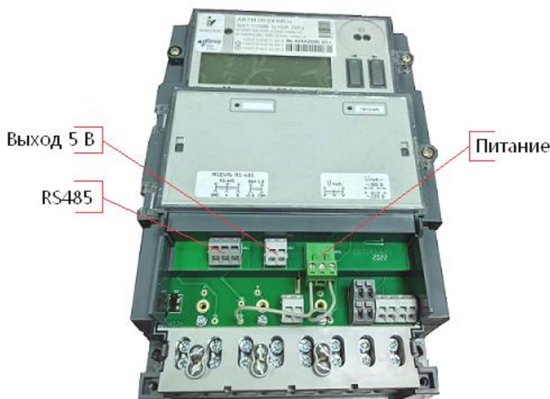
Рисунок 4.5 – Вид счетчика «Меркурий 234» с модулем RS485 с элементами подключения
