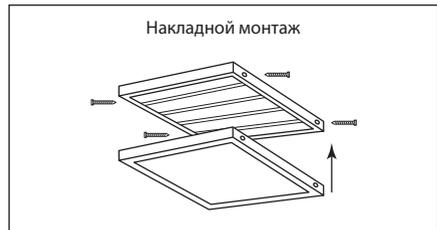
4. Снимите рассеиватель и установите светильник на опорную поверхность. Подключите светильник к сети 230 В через скрытую клемму внутри светильника. Установите рассеиватель.
