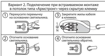
3. Подключите светильник к сети 230 В через скрытую клемму.
