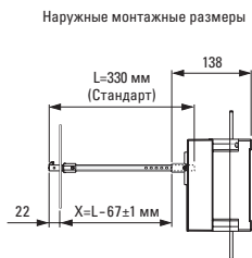
Рисунок 12в – Монтажные размеры при установке на дверцу шкафа для рубильников 250 А
