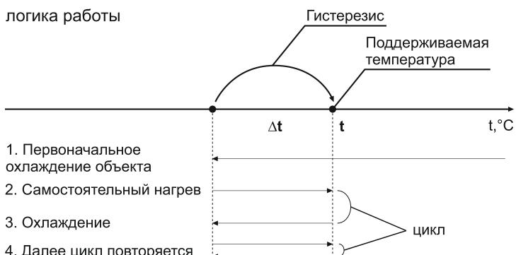
Гистерезис - это разница между температурой включения и отключения контактов терморегулятора (падение температуры).
