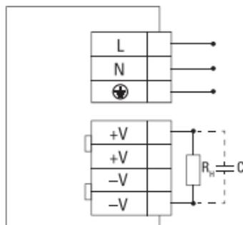
Рис. 1 Схема подключения блока питания
