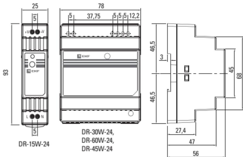
Рис. 2 Габаритные размеры блока питания.
