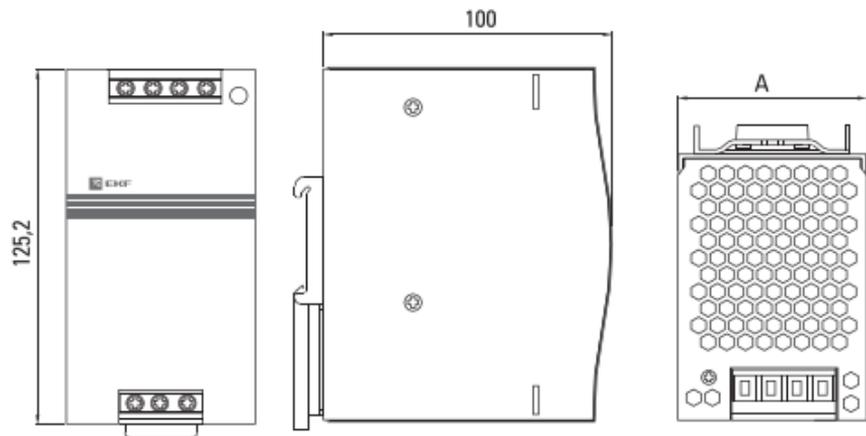
Рис. 3 Габаритные размеры блока питания DR-75W-24, DR-120W-24, DRP-240W-24.
