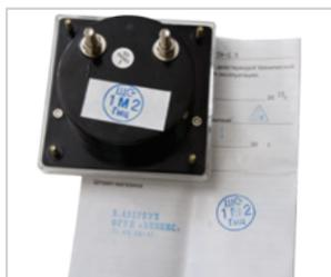
Приборы поверенной линейки имеют все соответствующие штампы на корпусе и в паспорте.
