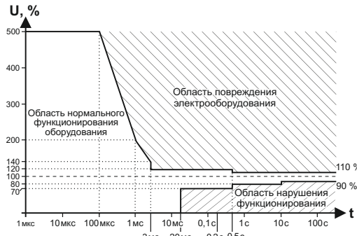
Рис. 1. Кривая работы электрооборудования ITIC (CBEMA), ( http://www.home.agilent.com/upload/cmc_upload/All/1.pdf?&cc=UA&lc=eng ).
