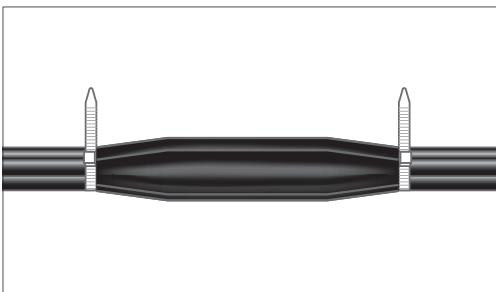
7.9. Сжать жилы вместе, как можно ближе друг к другу. В сжатом состоянии в местах окончания трубок для изоляции соединителей/гильз наложить бандажи с помощью нейлоновых хомутов. Обрезать свободные концы нейлоновых хомутов.
