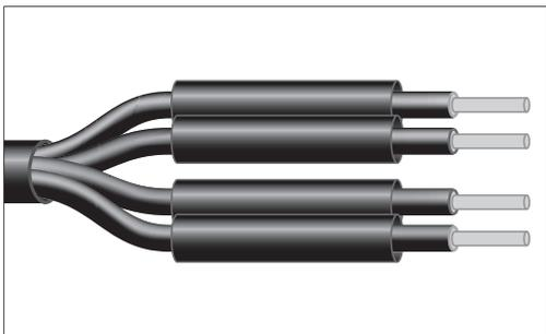
7.5. Надеть на жилы одного из кабелей трубки изоляции соединителей/гильз и сдвинуть их в сторону разделки кабеля до упора.
