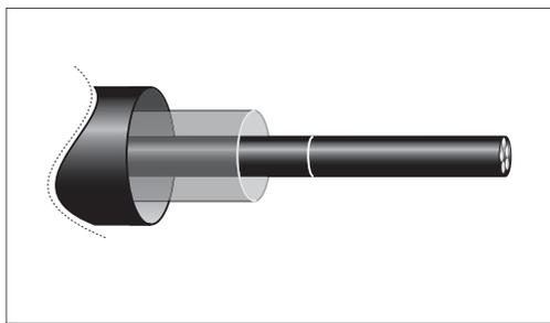
7.2. Для защиты внутренней поверхности трубки-кожуха надвинуть на конец одного из соединяемых кабелей полиэтиленовый рукав (для муфт на сечение 10/25, 25/50 и 70/120 мм<sup>2</sup> используйте рукав упаковочный, предварительно обрезав его торцы, для муфт на сечение 150/240 мм<sup>2</sup> используйте монтажный рукав из комплекта муфты). Поверх полиэтиленового рукава надеть трубку-кожух.
