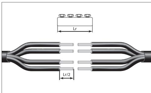
7.4. Развести жилы каждого из соединяемых кабелей так чтобы они попарно расположились стык в стык друг с другом. Радиус изгиба жил должен быть не менее 10-кратной высоты сектора или диаметра жил по изоляции.
