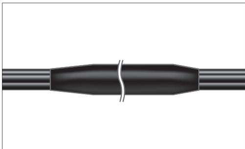
7.11. Монтаж муфты закончен. Дать ей остыть, прежде чем подвергать какому-либо механическому воздействию.
