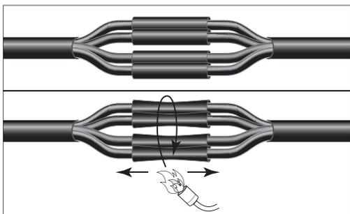
7.7. Надвинуть на соединители/гильзы трубки изоляции соединителей/гильз и выровнять их симметрично.
