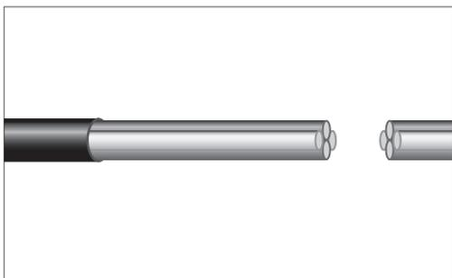
7.3. Удалить оболочку кабеля до ранее сделанного разреза на обоих кабелях.
