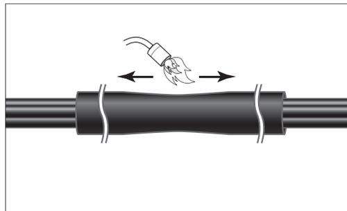
7.10. Надвинуть трубку-кожух на место соединения кабелей, расположить ее симметрично относительно центра соединения.
