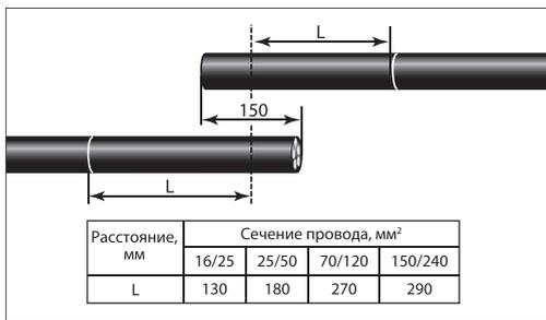
7.1. Распрямить концы соединяемых кабелей на длине не менее 1000 мм каждый. Уложить внахлест. На расстоянии L (согласно таблицы) от центра перехлеста сделать кольцевые надрезы оболочки кабеля. Обрезать кабели по центру перехлеста.
