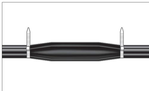
7.8. Сжать жилы вместе, как можно ближе друг к другу. В сжатом состоянии в местах окончания трубок для изоляции соединителей/гильз наложить бандажи с помощью нейлоновых хомутов. Обрезать свободные концы нейлоновых хомутов.
