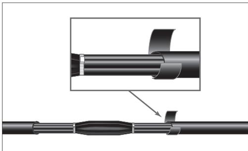
7.9. Оболочку обернуть по срезу кабель-герметиком ГКВ на обоих соединяемых кабелях.
