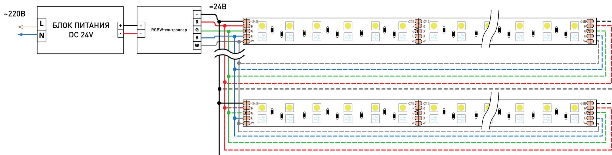
4. Ленту можно разрезать на отрезки с минимальным количеством светодиодов. Каждая линия отреза отмечена черной полоской и по обе стороны имеет две пары контактных площадок для дальнейшего соединения.
