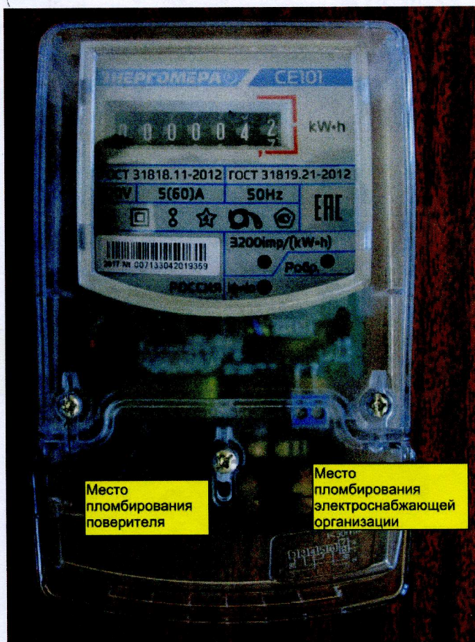
Рисунок 4 - Общий вид счетчика CE 101 S4
