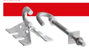
Крюк универсальный CS16, CF16 применяется для крепления анкерных или поддерживающих зажимов на железобетонных, металлических или деревянных опорах. Крепление производится двумя полосками металлической ленты. Крюк выполнен из оцинкованной стали с высокой устойчивостью к коррозии.
