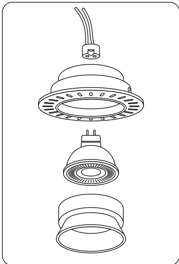
Рефлектор светильника, фиксирующий лампу, является съемным, что позволяет без усилий заменить ее в случае необходимости.
