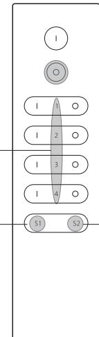
**Шаг 2:** Нажмите и удерживайте кнопку включения или выключения одной из четырёх зон, чтобы настроить желаемую яркость для каждой отдельной зоны
